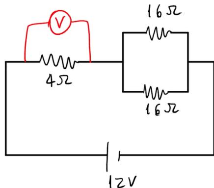
Se o valor das resistências dobrarem, a variação da tensão marcada pelo voltímetro será de:
