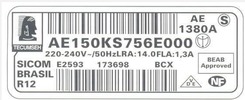
Etiqueta de identificação do compressor com indicação dos valores de FLA e LRA
