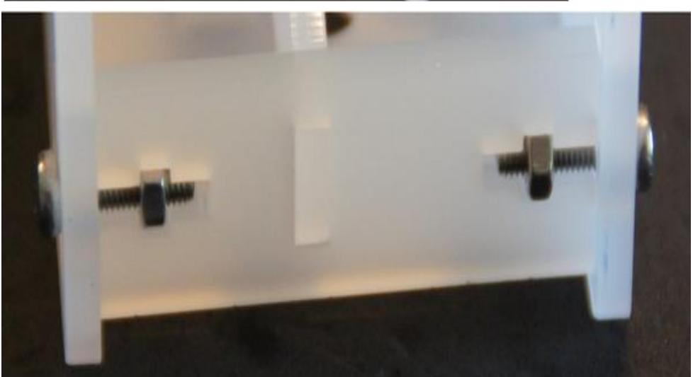
Utilizaremos também o suporte que acompanha o servo e 2 parafusos que acompanham o kit do servo, e parafusos na parte inferior do corpo do braço, conforme imagem abaixo:
