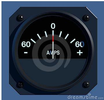
O amperímetro indica a corrente da bateria. Se a corrente for negativa, a bateria está sendo descarregada. Essa situação é anormal se o motor estiver em funcionamento e deverá ser corrigida antes do voo. Algumas das possíveis causas são as falhas do gerador ou regulador de voltagem.
