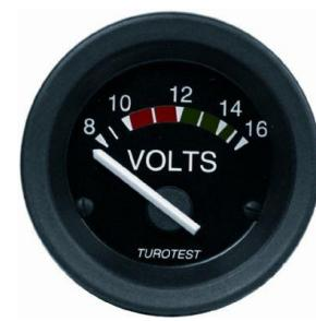
O voltímetro indica a tensão na barra principal. Tensões acima da faixa verde indicam sobrecarga de bateria, e tensões abaixo indicam carga baixa. Ambas as situações causam deterioração e inutilização da bateria, portanto exigem verificações dos sistemas elétricos.
