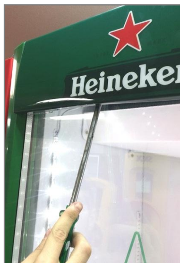
Retire a testeira (fixada com fita dupla face) e fixe a nova testeira com o display.
