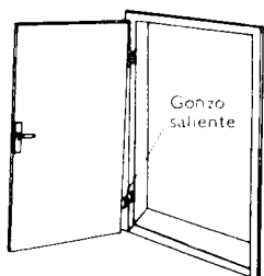
9 Porta corretamente pendurada. Ao abri-la sobe e fecha-se por si.
