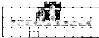
2 Planta corrente com duas naves. Solução econômica devido às favoráveis condições estáticas. Inconveniente: coincidência forçada entre a estrutura e as salas de escritório → pag. 252. E. 1 : 1250 Arq.: P. Beluschi
