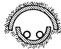
② Proteção dos canos com telhas de grés
