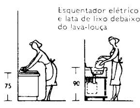
10 A altura de 85 cm, corrente nas mesas de cozinha está compreendida entre as mais indicadas para os trabalhos de amassar pastas e de lavar a louça
