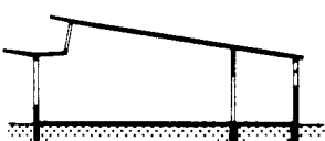
4 Luz unilateral superior e baixa. A pala de betão protege os vidros da incidência direta
