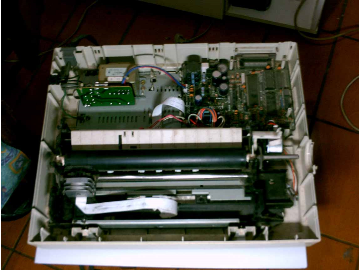
Figura 02.7: aparência da impressora LX 810 ao abri-la
