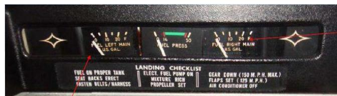
Marca a quantidade de combustível nos tanques de combustível. Geralmente é um instrumento elétrico que recebe um sinal de um transmissor localizado no tanque.
