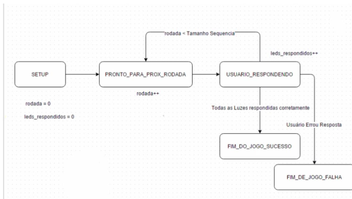
Dessa maneira, no `SETUP` os `leds_respondidos` são iniciados, no `PRONTO_PARA_PROX_RODADA` a rodada é incrementada e no `USUARIO_RESPONDENDO` ela é incrementada a medida que os LEDs forem respondidos. Isso significa que na volta para o `PRONTO_PARA_PROX_RODADA` temos que pensar um pouco. Se sempre só ficarmos incrementando os LEDs isso significa que nesse trecho do `USUARIO_RESPONDENDO` para o `PRONTO_PARA_PROX_RODADA` sempre ficaremos fazendo uma conta.
