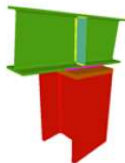
31. Ligação Viga contínua apoiada sobre pilar
