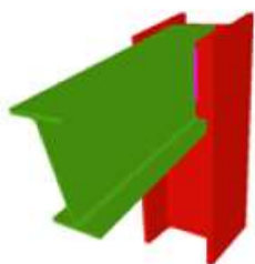
29. Ligação Pilar – viga articulada na alma do pilar
