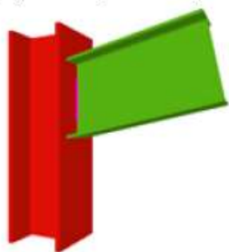
27. Ligação Pilar (contínuo) – Viga articulada
