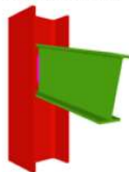
30. Ligação Pilar (contínuo) – viga articulada na alma do pilar
