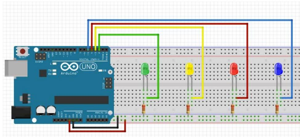
Lembre-se: Proteja os LEDs utilizando um resistor!
