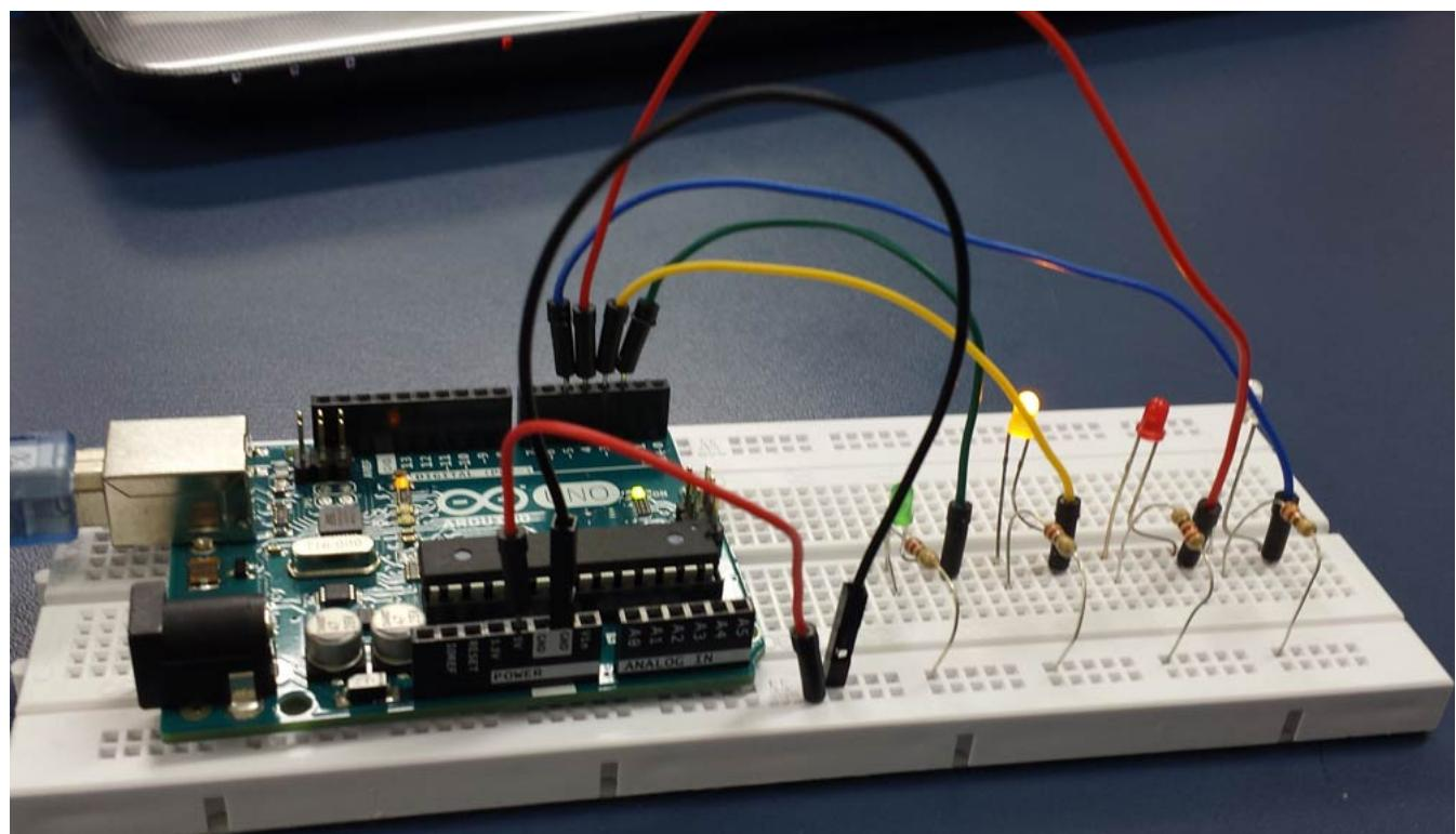
Uma vez montados os 4 LEDs com seus respectivos resistores, chega a hora de colocar os botões. Sempre um botão ao lado de cada LED. O resultado final deve ser parecido com o circuito abaixo:
