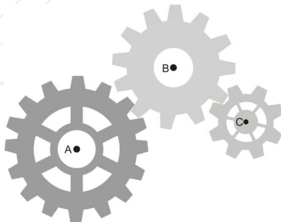
Nesse sistema, uma pessoa gira a engrenagem A em média de 2 rotações por segundo. A engrenagem C está conectada à cesta da centrífuga por meio de um eixo, e, conforme ele gira, a cesta também gira. Considerando que as engrenagens não deslizam, a frequência de rotação da cesta, em rpm, é
