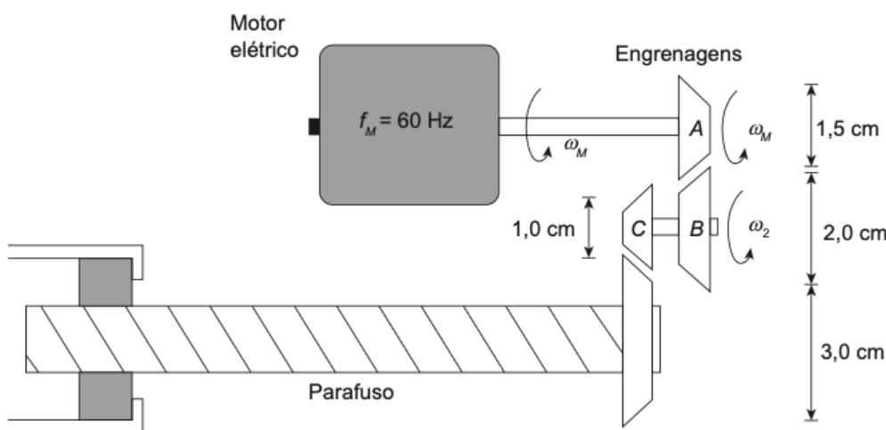
Qual a frequência de rotação do parafuso do atuador?
