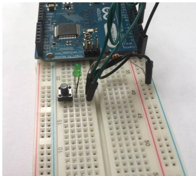
Ainda, estamos utilizando um pequeno cabo preto para fazer a conexão dos botões com a linha de GND.
