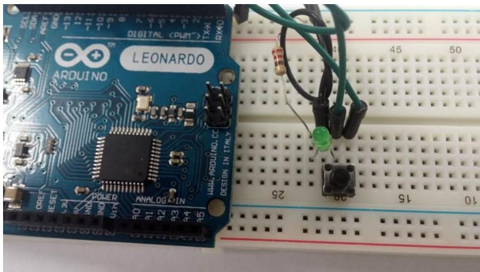
Outro detalhe importante que você deve notar, é que estamos utilizando o espaço entre os 2 terminais(as perninha) do botão para colocar a parte positiva do LED.
