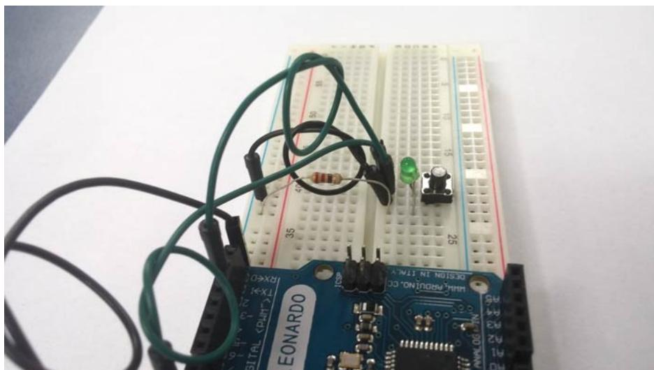
Visão lateral, utilizamos o resistor para fazer a ponte entre a parte negativa do LED e a linha do GND.
