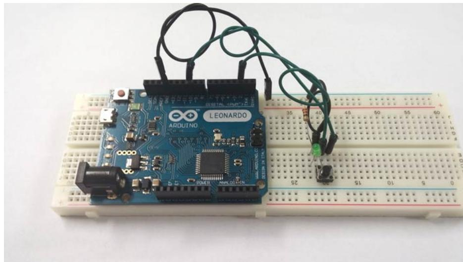
A primeira coisa que você deve ter notado é que deixamos de usar o GND (Ground) da parte de baixo do nosso Arduino, fizemos isso para isolar a parte de cabos que ligam ao terra da parte de cima da protoboard. Dessa maneira, deixamos espaço livre para o acesso ao botão embaixo. Estamos usando o GND que fica ao lado das portas digitais do Arduino e usando a linha de cima para o Ground.
