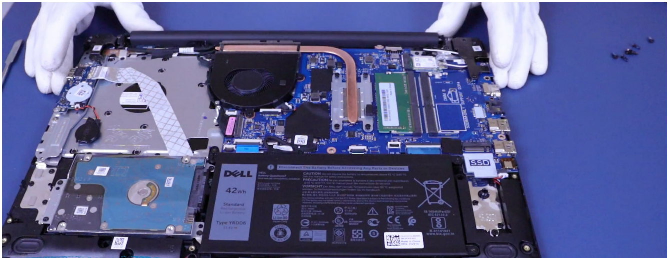
Figura 21.4: já neste exemplo foi necessário retirar toda a tampa/carcaça traseira
