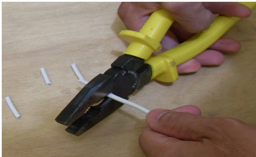
Figura 11.2: ao usar um alicate, a força aplicada no cabo é transferida à cabeça
