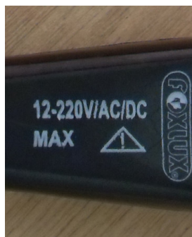
Figura 11.22: informações de tensão mínima e máxima na chave
