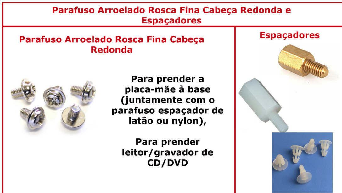
Figura 12.6: parafusos arroelados rosca fina cabeça redonda e espaçadores
