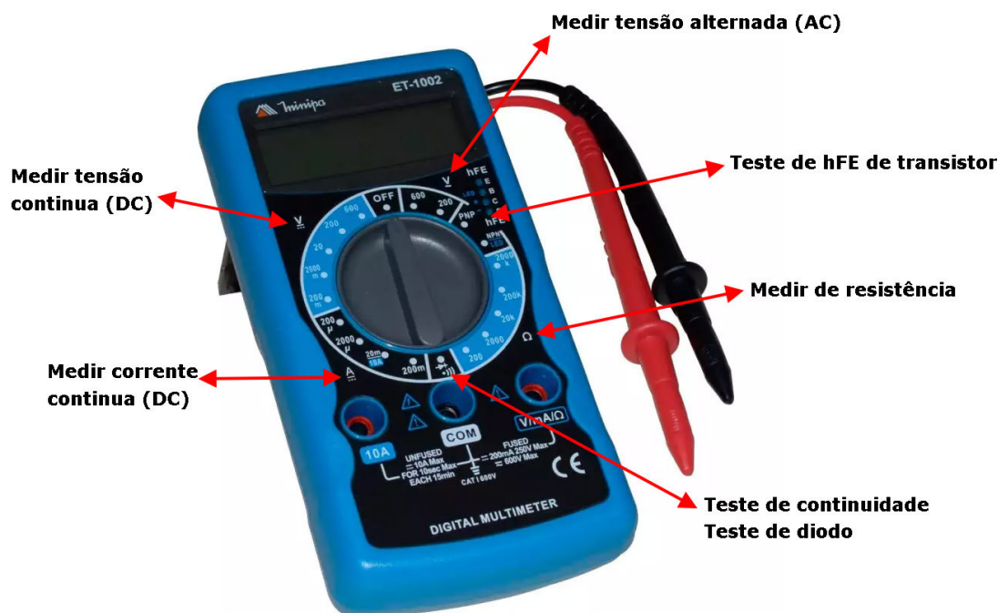
Figura 18.5: entenda o multímetro Minipa ET-1002
