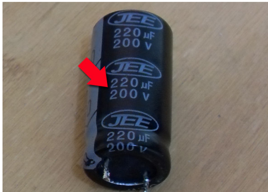
Figura 22.11: informações de capacitância e voltagem
