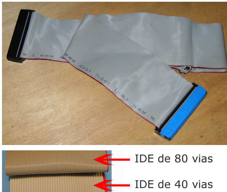
Figura 12.44: Cabo flat de 40 e 80 vias
