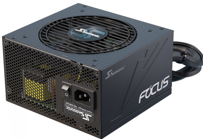
Figura 03.7: parte traseira de uma fonte Seasonic Focus. Esse modelo em questão não possui a chave seletora 115V/230V. Ela faz a seleção automaticamente.
