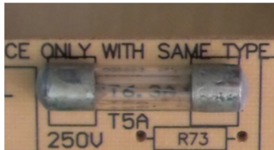
Figura 03.8: Esquema simplificado do uso de fusível cilíndrico de vidro
