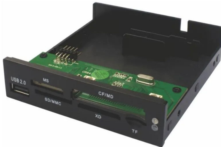
Figura 05.2: um leitor de cartões de memória para PC. Este inclui uma porta USB 2.0
