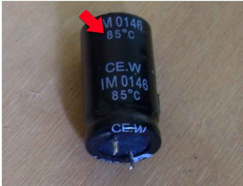
Figura 22.12: informações de temperatura máxima suportada
