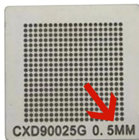
Figura 23.31: diâmetro da esfera. Nesse exemplo é 0.50mm.
