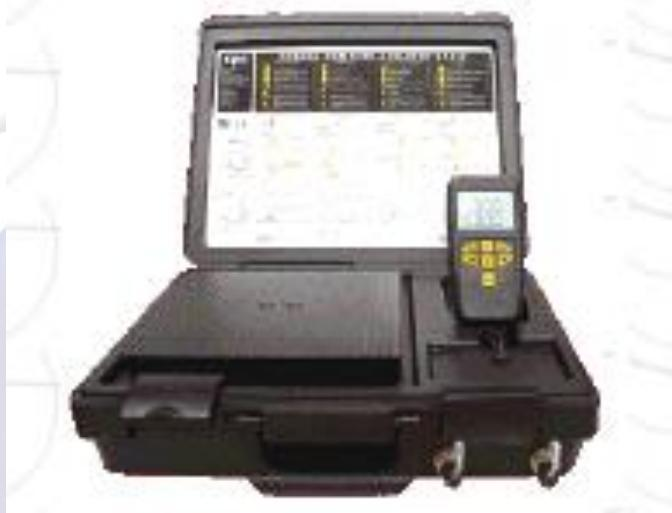
*Balança automática para carga de fluido refrigerante*
