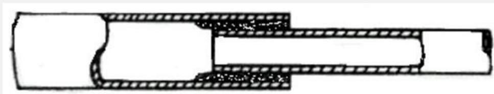
Porosidade de solda na tubulação
