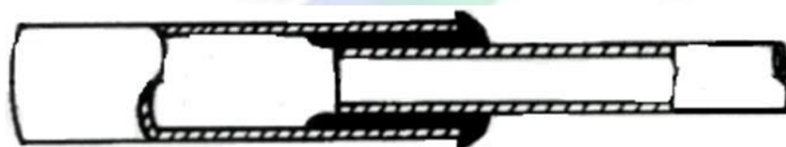
Brasagem com excesso de material de adição
