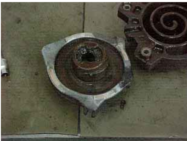
Vista interna da região da bucha acidez formada por excessiva umidade
