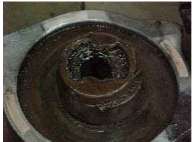
Degradação do óleo umidade excessiva
