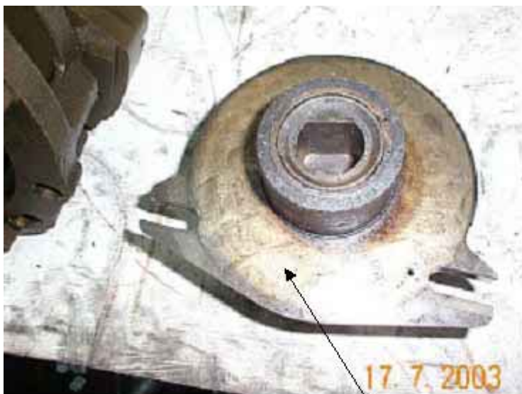
Desgaste provocado por lubrificação deficiente
