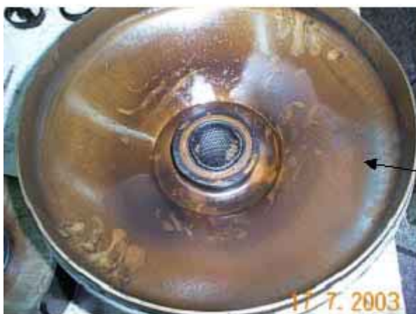
Desgaste provocado por lubrificação deficiente
