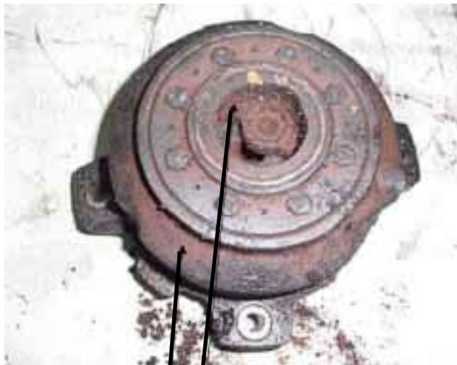
Parte superior do Scroll com muita sujeira e umidade
