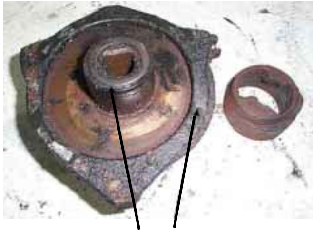
Bucha do Scroll travada por excesso de sujeira e muita umidade
