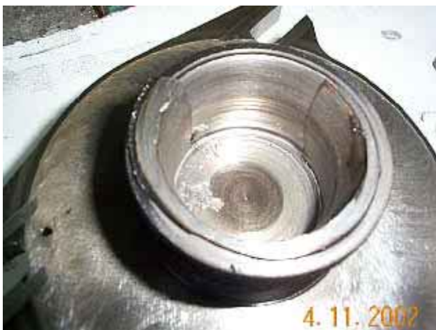
Desgaste excessivo provocado por lubrificação deficiente
