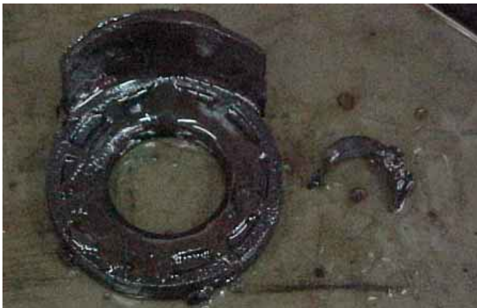
Danos ao came / Degradação por alta temperatura de descarga
