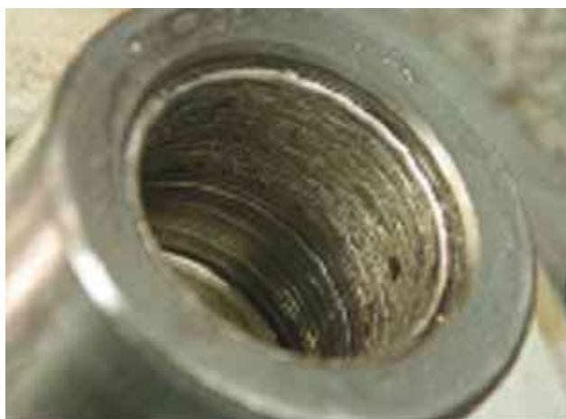
Remoção do lubrificante por refrigerante
