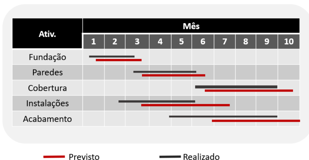
Figura 41: exemplo de diagrama de Gantt mostrando o previsto e o realizado
