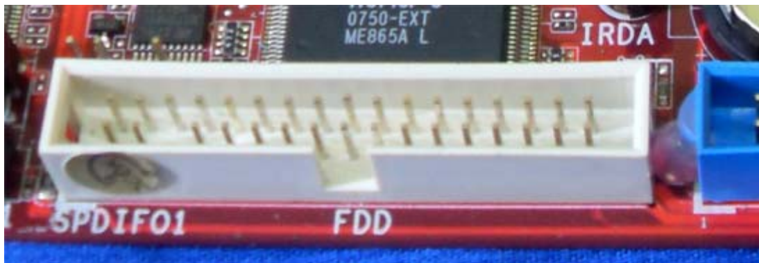
Figura 31: conector FDD na placa-mãe
