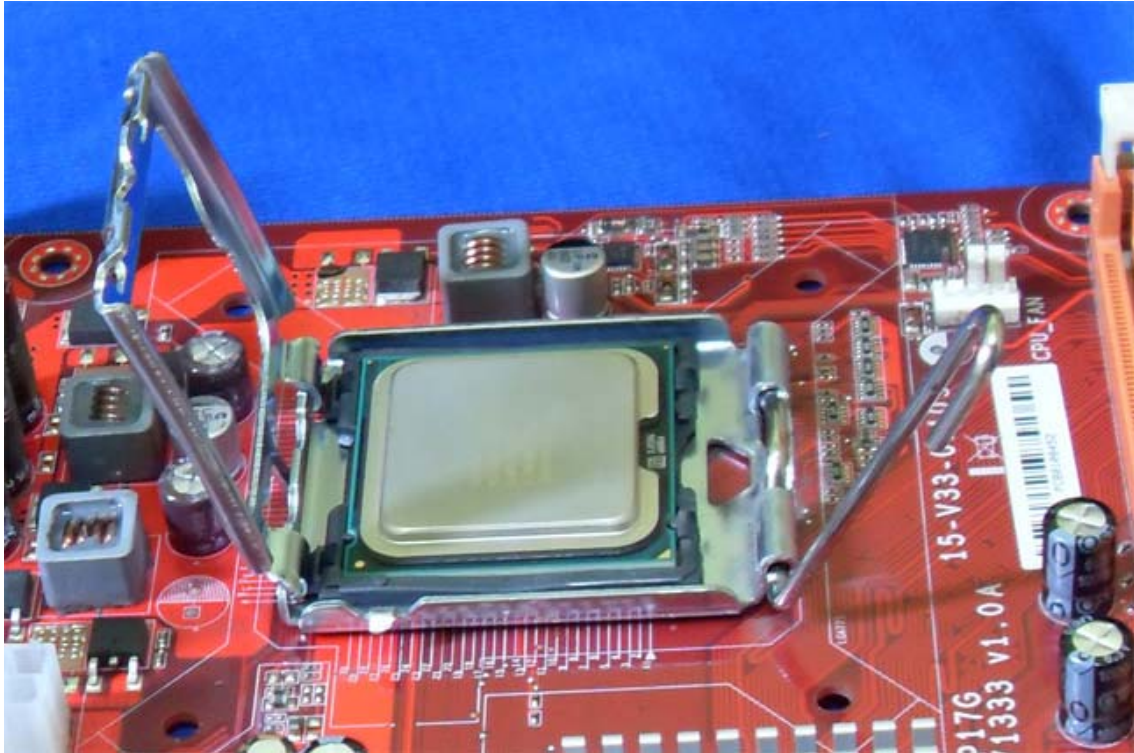
Figura 14: processador perfeitamente encaixado no soquete LGA775
