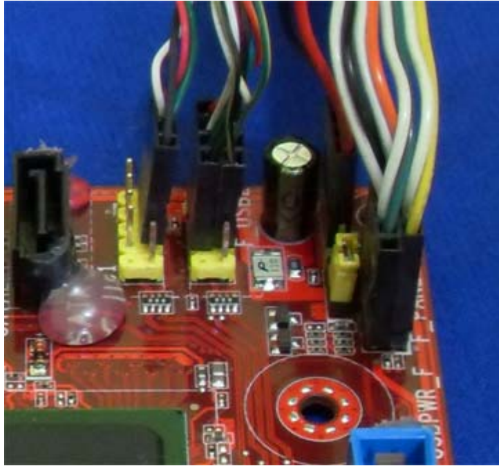
Figura 20: conectores do painel frontal e auto-falante
