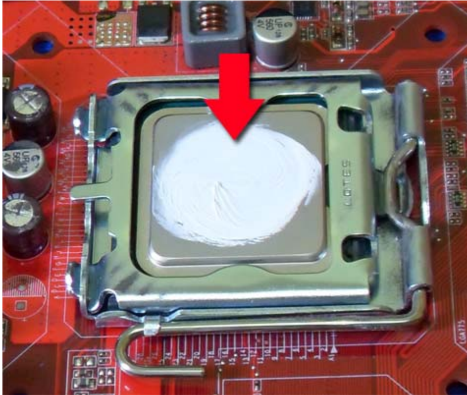
Figura 16: uma fina camada de pasta térmica sobre a superfície de contato do processador
