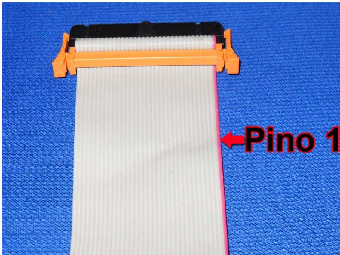
Figura 26: pino 1 em um cabo flat. Observe a listra de cor diferente
