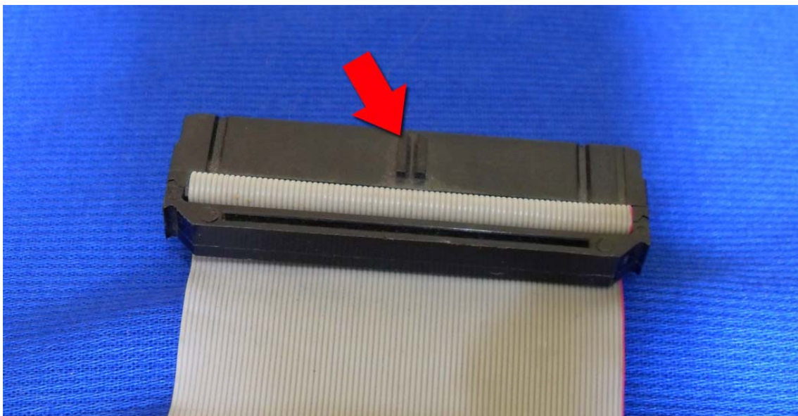
Figura 28: guia de encaixe no conector no cabo flat
