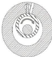
Final de cada ciclo de sucção e compressão
