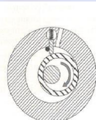
Início dos processos de sucção e compressão
