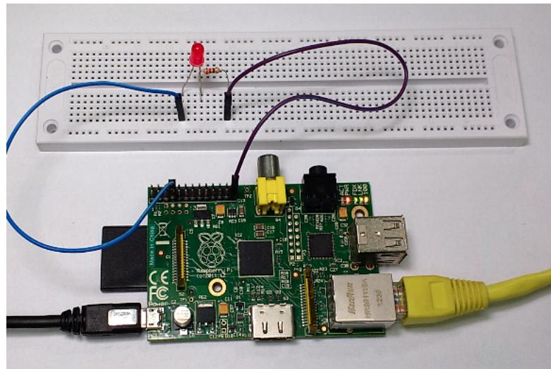
Para acender o LED, primeiramente devemos nos conectar remotamente ao Raspberry PI, utilizando o SSH ou VNC, como visto no treinamento anterior:
