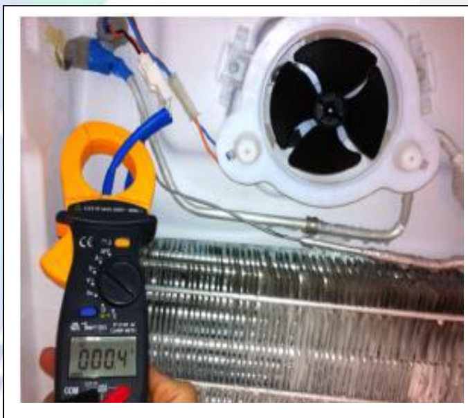
Medição da corrente elétrica na resistência de degelo energizada
