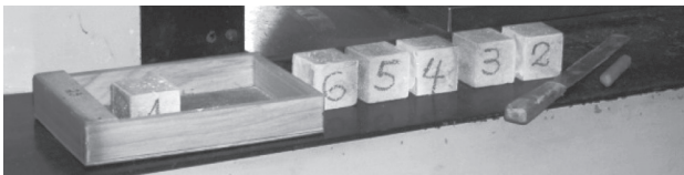
Figura 4 Corpos de prova de argamassa em cubos de 40 mm.
