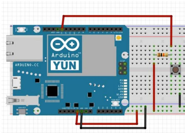
Uma vez montado, abra o ArduinoIDE e comece um novo *sketch* (novo programa). Na função `setup`, inicialize a porta 13 como `INPUT` e na função `loop`, leia o estado da porta:
