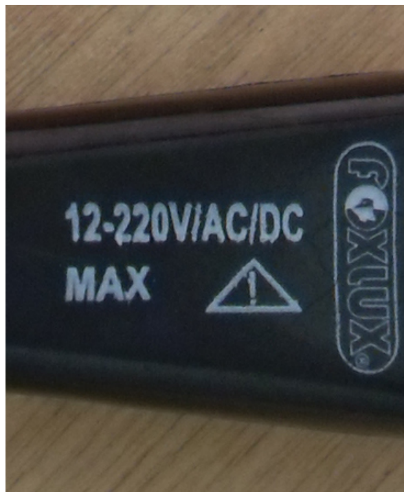
Figura 03.22: informações de tensão mínima e máxima na chave
