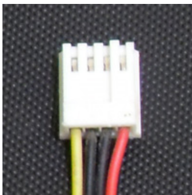
Figura 06.13: pinagem do conector para dispositivos de 3 ½"
