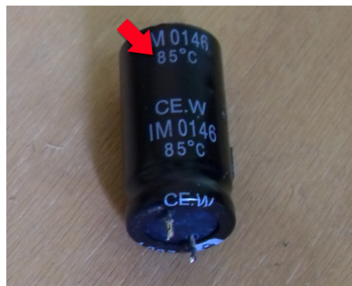
Figura 04.7: informações de temperatura máxima suportada
