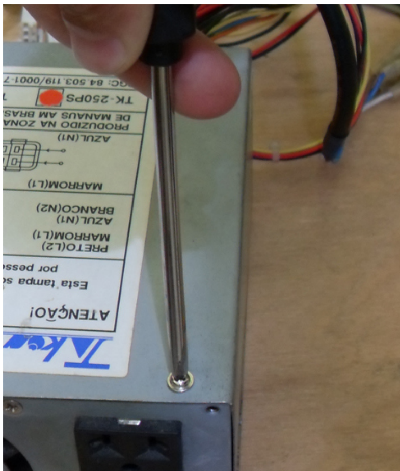
Figura 03.10: retirando o parafuso de uma fonte com uma chave Phillips
