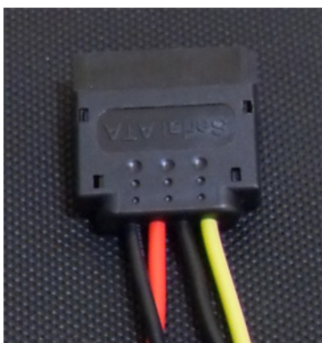
Figura 06.14: tensões dos fios do conector para dispositivos SATA
