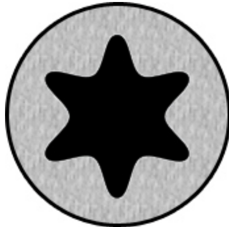
Figura 03.14: cabeça de um do tipo torx
