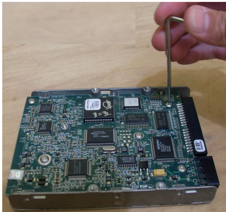
Figura 03.13: retirando um parafuso de um HD com uma chaves torx
