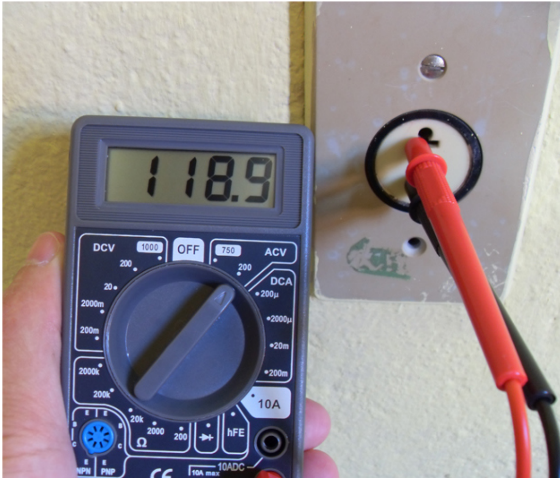
Figura 03.42: medição de uma tomada 110V
