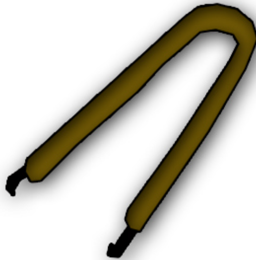
Figura 03.15: uma pinça extratora de chip de memória DIP
