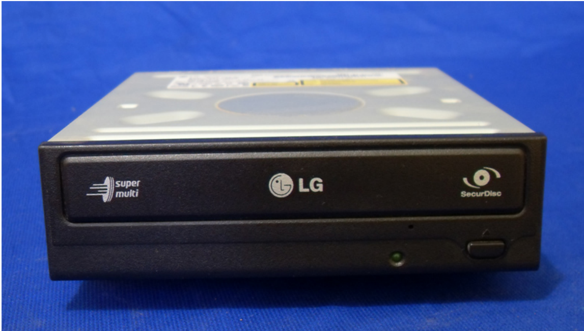
Figura 07.16: um drive óptico (nesse caso, é um gravador de DVDs)
