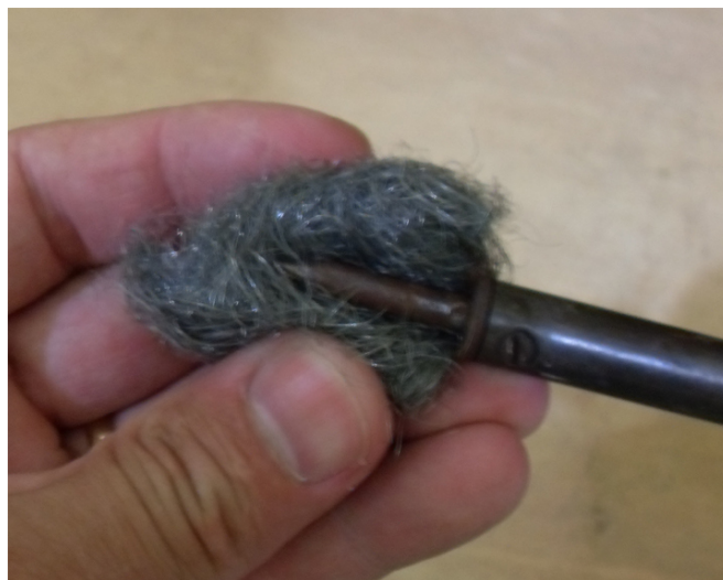
Figura 03.29: limpando a ponteira com uma esponja de aço
