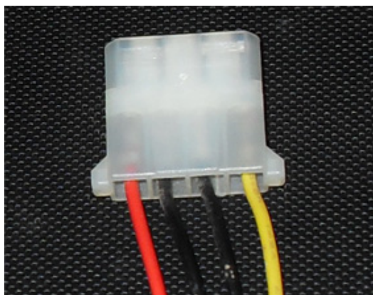
Figura 06.12: pinagem do conector para dispositivos de 5 1/4"
