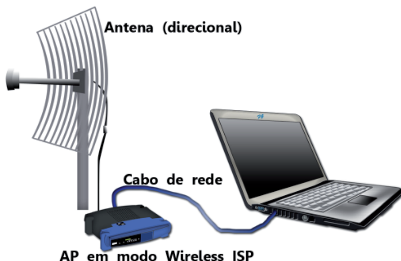
Figura 04.5: nesse esquema, observe que a antena tem o papel de se comunicar diretamente com a antena do provedor, obtendo, dessa forma, acesso à Internet. Outro detalhe, é que no nosso exemplo o cabo de rede está ligado diretamente a um notebook. Mas, ele pode ser conectado a um hub/switch, para que mais nós possam desfrutar da Internet.
