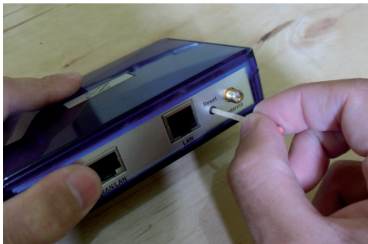
Figura 03.11: use um palito de fósforos (ou algum objeto pontiagudo e fino) para resetar o AP. Mantenha pressionado o botão durante uns 10 segundos.
