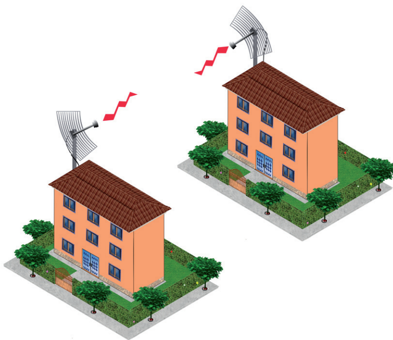
Figura 04.2: exemplo da utilização do modo bridge ponto a ponto. Observe que aqui temos a representação de dois imóveis onde, cada um possui uma rede (LAN ou WLAN), e, que são interligadas graças as antenas wireless.
