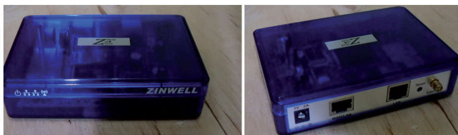
Figura 01.3: AP usado nessa publicação. Modelo Zplus G220 da Zinwell.
