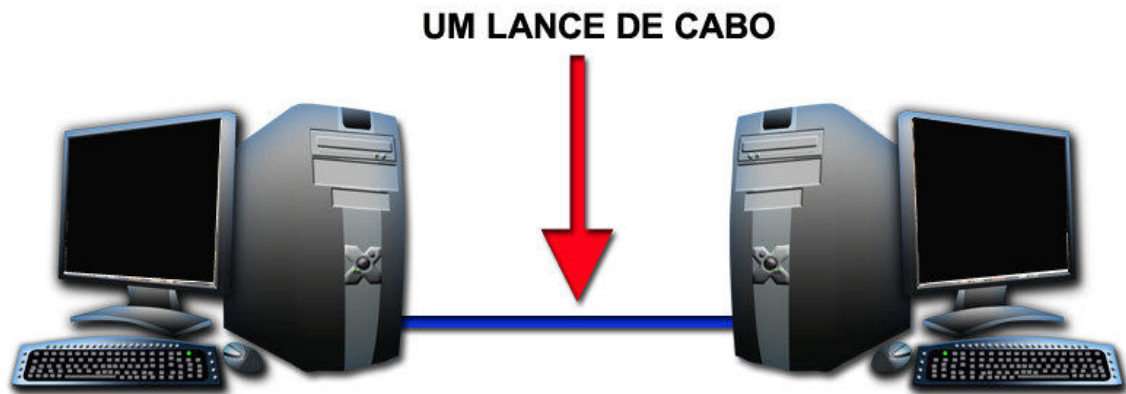
Figura 01.3: um lance de cabo. Observe que um lance de cabo interliga os dois computadores, sem que haja nenhum equipamento entre suas extremidades.
