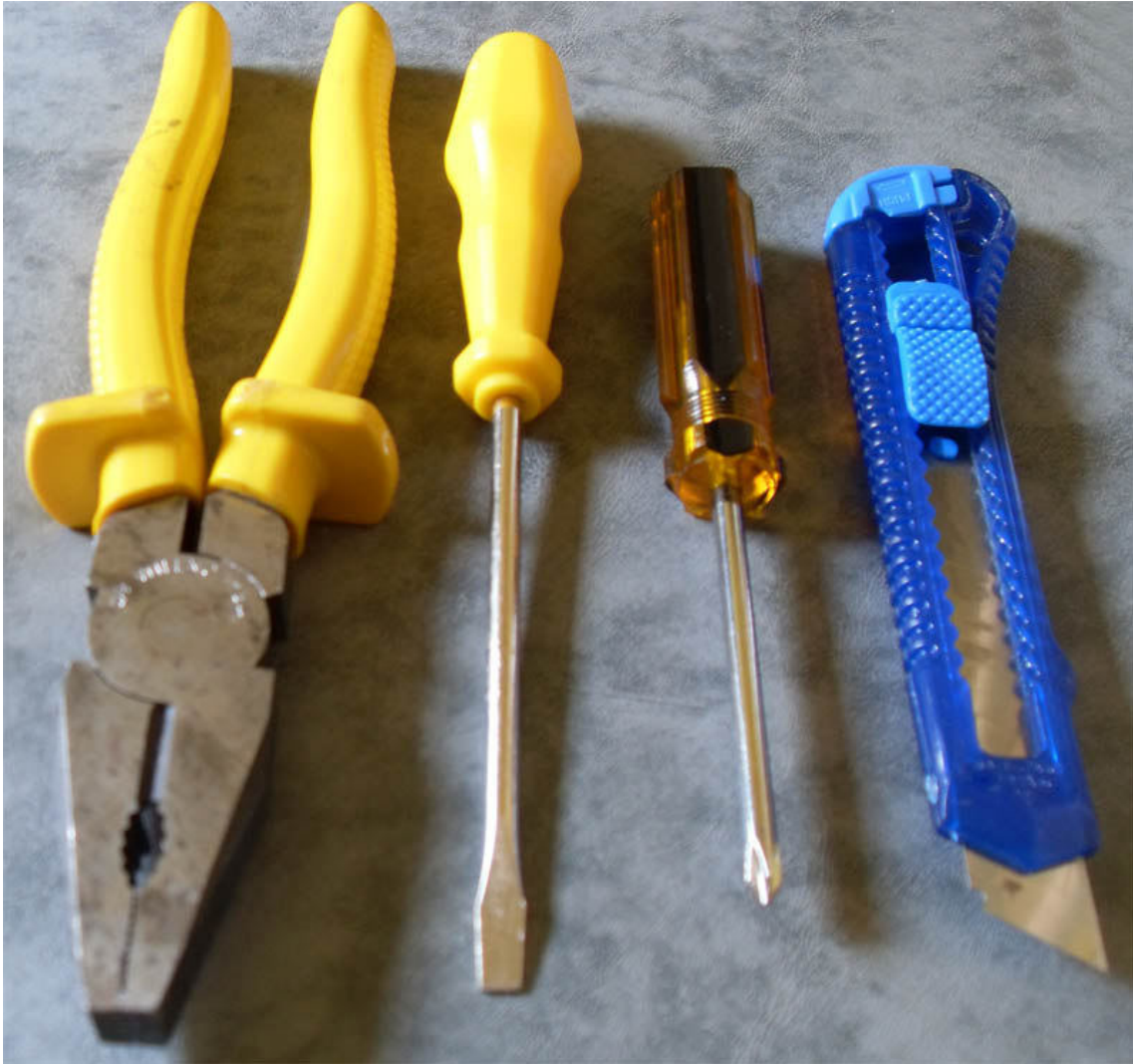
Figura 01.8: da esquerda para direita: alicate universal, chave de fenda, chave phillips e estilete.
