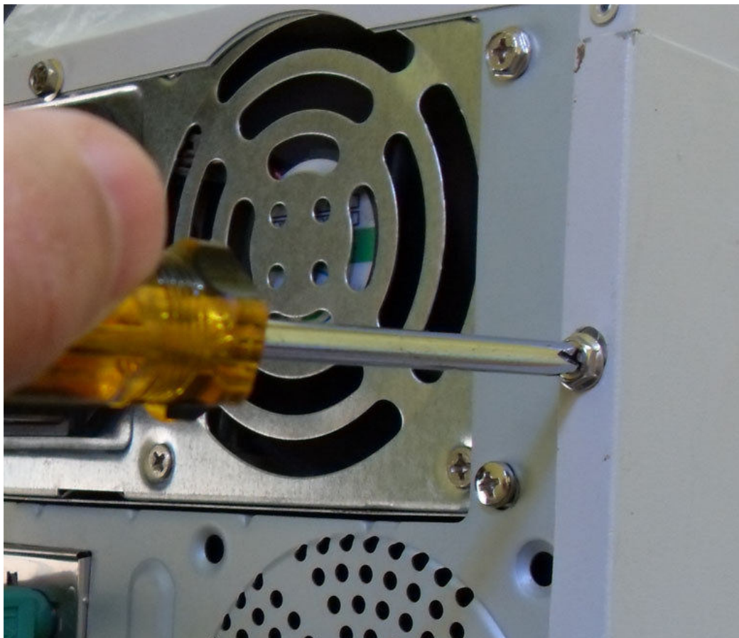
Figura 02.1: retirada da tampa do gabinete.
