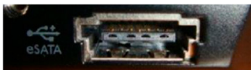
Figura. Conector eSATA localizado na lateral de um notebook
