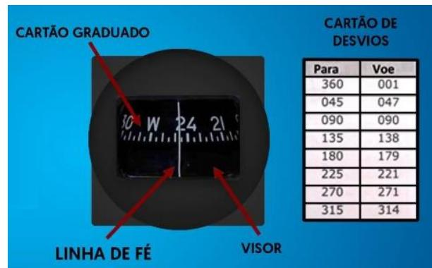
OBS: Para tentar diminuir as influências magnéticas próximas às bússolas (motor, magnetos, etc.) são instalados nas bússolas compensadores magnéticos. Envoltas com líquido chamado Xileno ou Querosene.
