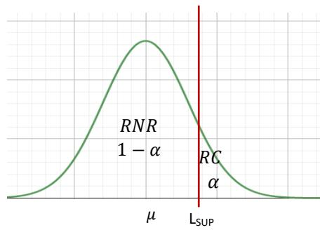
Esse teste é utilizado, por exemplo, quando precisamos colocar uma peça dentro de uma outra. Se a peça for menor do que a média estipulada (digamos,  $\mu = 2$  cm), não haverá problema, pois ela caberá dentro da outra; porém, se ela for maior do que determinado limite, não será possível trabalhar com ela.
