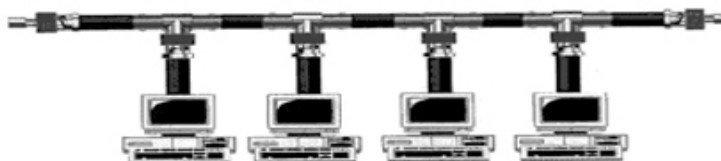
Figura - Topologia em Barramento (ou Linear)
