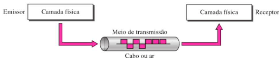
Figura. Meio de Transmissão e a Camada Física Fonte: Forouzan (2008, p. 191)+
