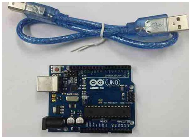
Vamos começar familiarizando-nos com o hardware. Primeiro, precisamos ganhar familiaridade com a parte metálica no canto superior esquerdo da placa. É nela que faremos a conexão USB e ligaremos o **Arduino**. Isso significa que é por
