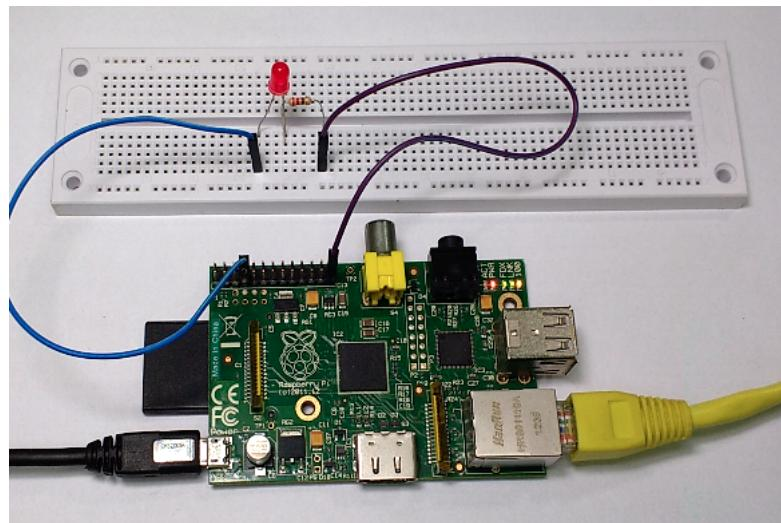
Para acendermos o LED, precisamos estar conectados ao Raspberry PI, seja com teclado e monitor, ou remotamente (SSH ou VNC).
