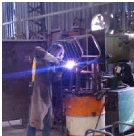
Radiação ultravioleta (não ionizante) gerada por atividade de soldagem (solda MIG)
