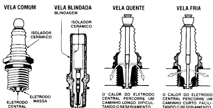
**Características gerais:** As velas possuem um eletrodo central, que recebe a alta tensão da bobina, e um ou mais eletrodos-massa ligados ao corpo da vela. Existe uma pequena folga entre os eletrodos central e massa, para que a faísca possa saltar. Se um dos eletros-massa tocar o eletrodo central, haverá um curto circuito e a vela não funcionará.
