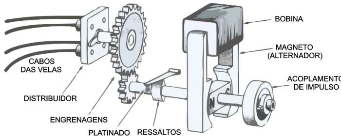
**2. O Princípio da geração da alta tensão:** As velas exigem uma alta tensão para produzir a centelha, e esta alta tensão é gerada pela bobina de alta tensão do magneto.
