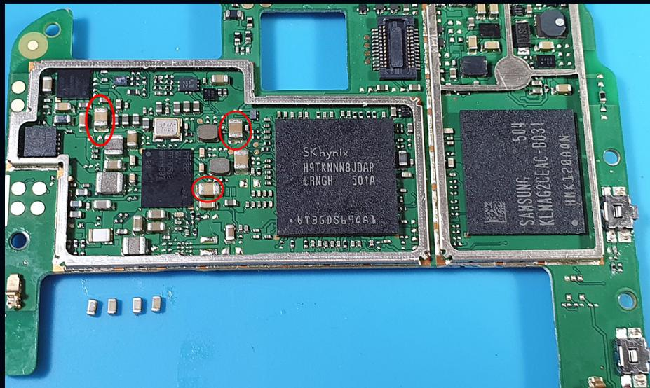
Representado pela letra **C** no esquema elétrico, o capacitor é um conjunto de duas placas condutoras de energia que normalmente são separadas por um material isolante.
