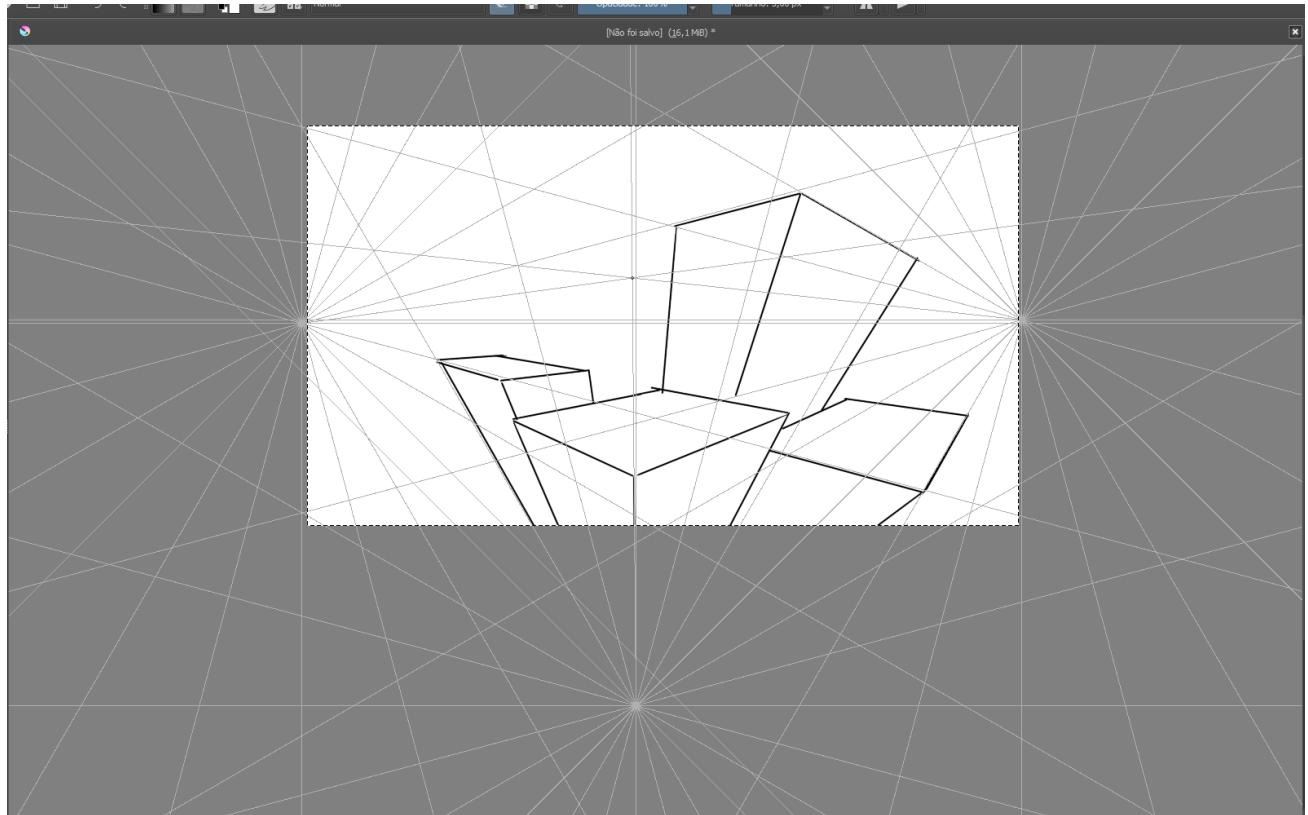
Para isso, basta criarmos três pontos de fuga, sendo dois paralelos na linha do horizonte e um abaixo ou acima do mesmo. Assim nós temos uma perspectiva com bastante distorção das formas, ideal para representar elementos grandes, como arranha-céus.
