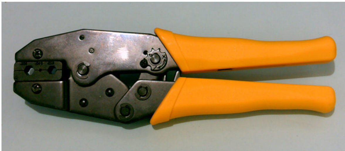
Figura 04.7: Alicate Crimpador para cabos coaxiais
