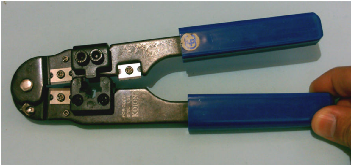
Figura 04.6: Alicate Crimpador para conectores RJ-45
