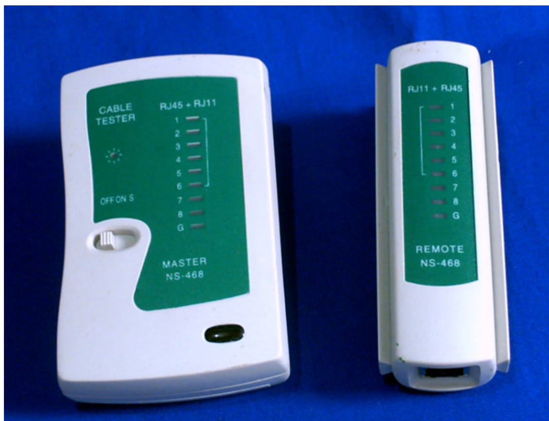
Figura 04.9: testador de cabos par trançado
