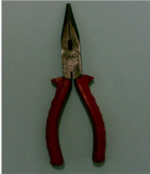
Figura 04.5: alicate de bico fino e longo
