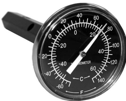
Quando uma aeronave se desloca dentro de uma massa de ar, o choque de partículas com a Haste provoca um aquecimento devido ao atrito, com consequente erro de indicação. Este, no entanto, considerando aeronaves desenvolvendo pequenas velocidades pode ser desprezado.
