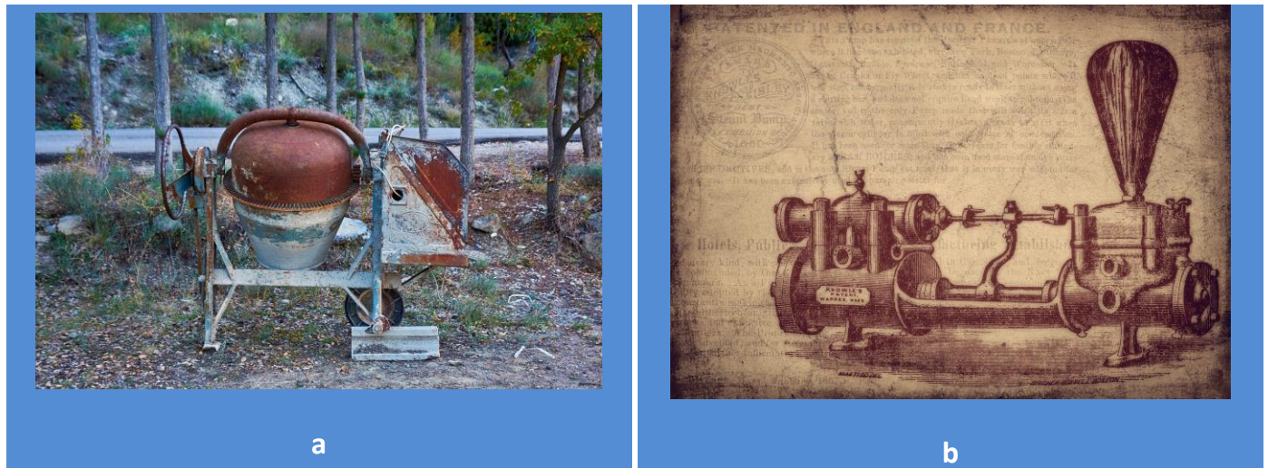
Figura 15: betoneiras (a) e bombas (b) são exemplos de equipamentos que não têm mão de obra associada ao seu custo horário
