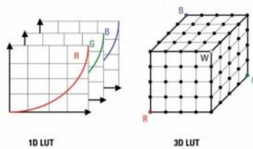
Existem 1D e 3D LUTs, a diferença é que 1D LUT só se aplica a um único canal de cor enquanto que um LUT 3D é uma matriz em forma de cubo para todos os três canais de cores, com todas e quaisquer combinações. Estaremos nos referindo a LUTs 3D a partir de agora, uma vez que este é o tipo mais comum e é na maioria das vezes o que se entende quando o termo "LUT" é empregado.
