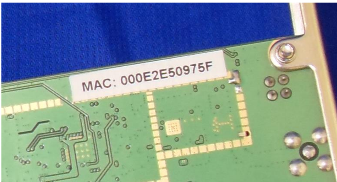
Figura 02.5: endereço MAC em uma placa de rede
