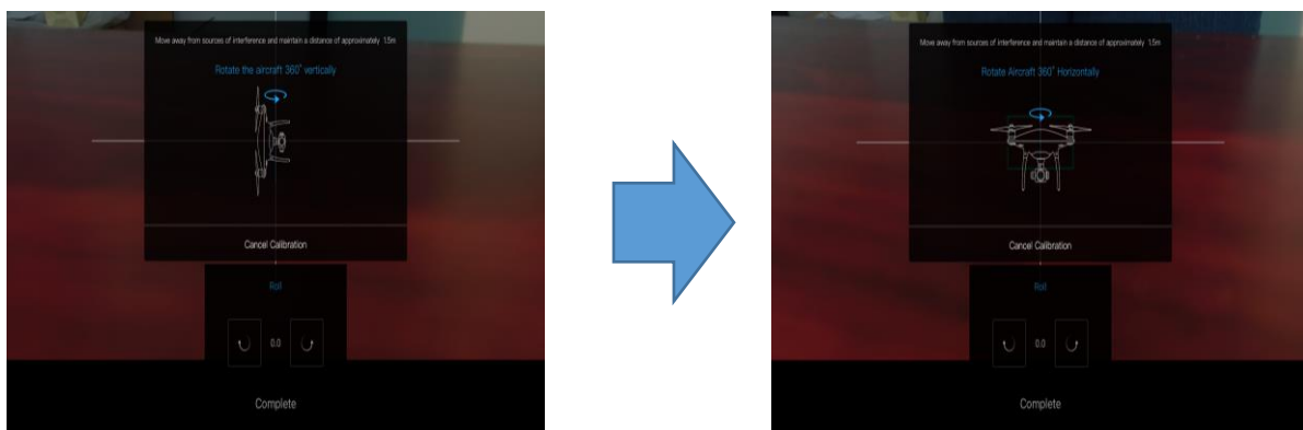
Figura 15. Pasos para calibrar el compass.
