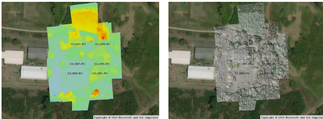
Figura 93. Modelo de Elevación Digital y Hillshade creados con el programa Drone Mapper Rapid.
