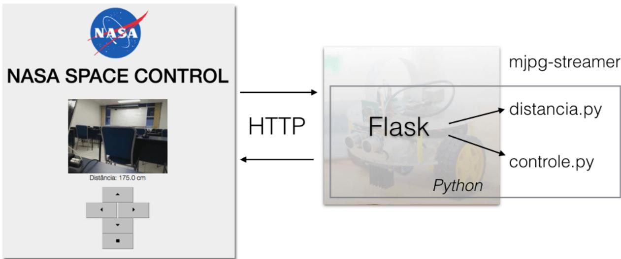
Repare que na imagem o **mjpg-streamer** não está dentro do retângulo do Flask. Isso porque ele já é uma aplicação pronta, que já possui um servidor web, podendo assim se comunicar diretamente com o navegador.
