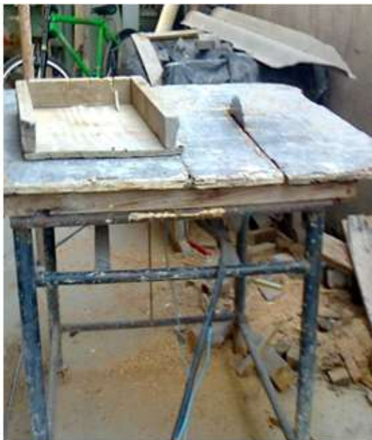
Serra circular em condições precaríssimas de uso: sem coifa protetora do disco, sem cutelo divisor, não há bloqueio de acesso, não há dispositivo empurrador
