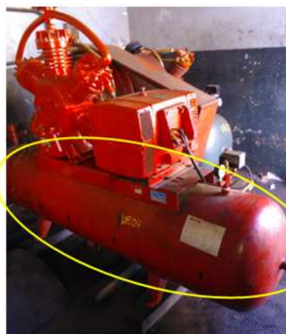
Vaso de Pressão (reservatório cilíndrico) Obs. Acima do vaso de pressão vemos um compressor de ar. A NR13 se aplica somente ao vaso de pressão. O compressor de ar deve estar de acordo com as determinações da NR12!
