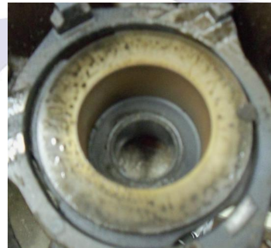
Partes mecânicas superaquecidas o que caracteriza falha na lubrificação.
