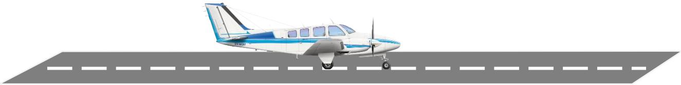
Na **fase final** a acft já está veloz e gerando sustentação suficiente para sair do chão com segurança. A velocidade para sair do chão corresponde a velocidade de rotação e esta é cerca de 120 a 130% da velocidade de estol. O atrito do avião com o solo é praticamente nulo porque existe pouco contato das rodas com o solo, já que a sustentação contrapõe parte do peso.
