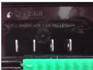
Detalhe: conexões das saídas e gaxeta de vedação
