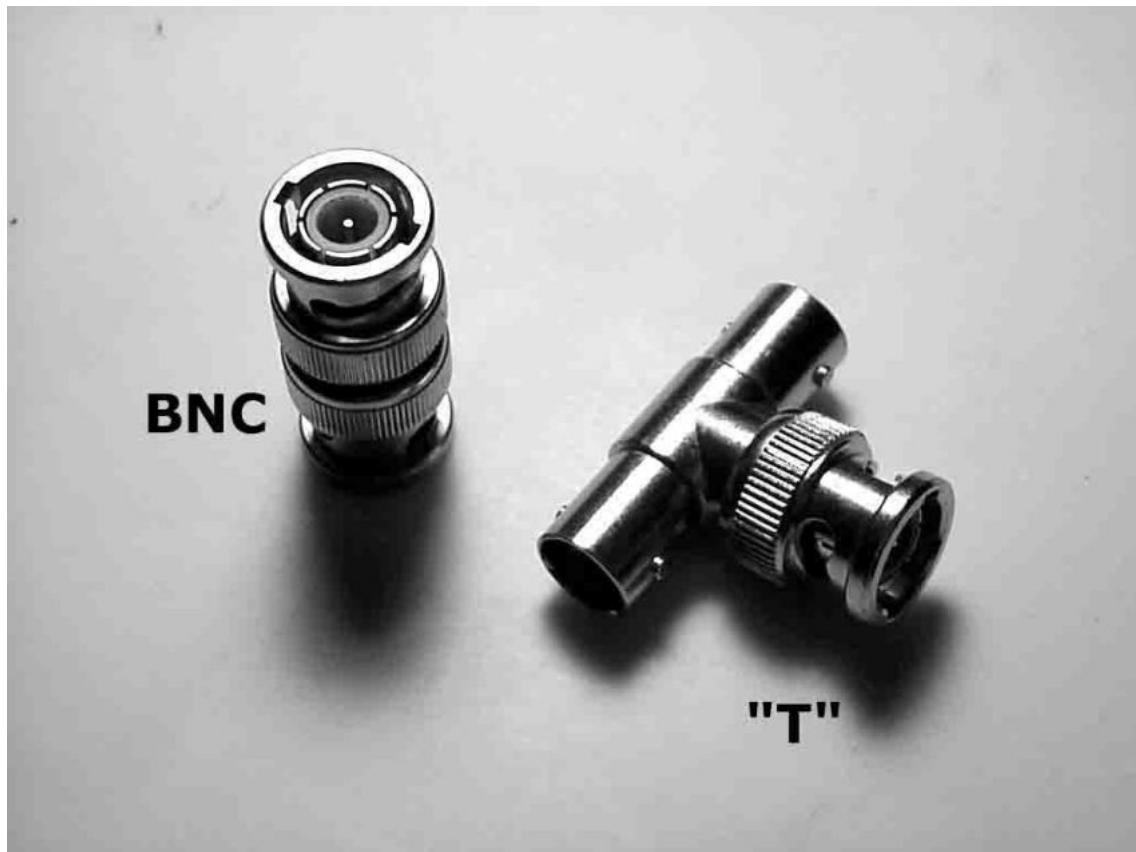
.31: conector BNC que é usado no cabo e conector “T”
